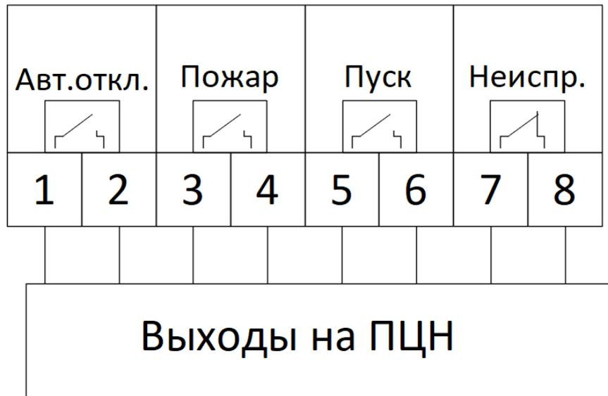
Рисунок 12 – Контакты для подключения выходов на ПЦН.
